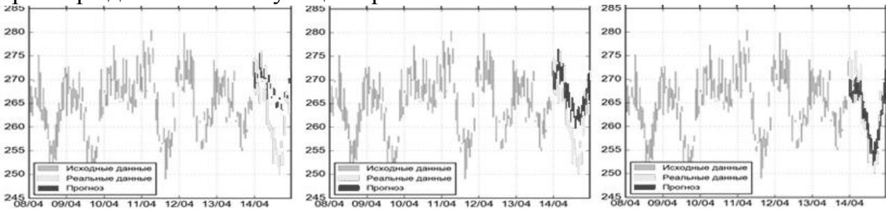
Рисунок 4 - Прогнозы для выходных давлений ПРГ в составе ГС, полученные с помощью интервальных версий модели на базе многослойного перцептрона MLP<sup>I</sup>, модели на основе сети долгой краткосрочной памяти LSTM<sup>I</sup> и гибридной модели, построенной путем комбинирования алгоритмов HoltWinters<sup>I</sup> и MLP<sup>I</sup>
