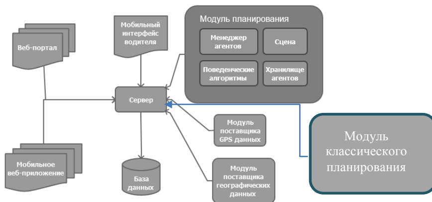
Рис. 2. Архитектура системы управления мобильными ресурсами
