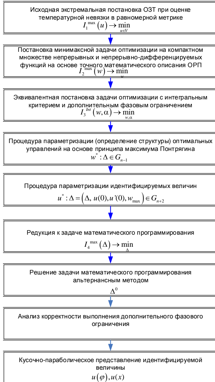
Рис. 2.2. Регулярная процедура минимаксной оптимизации в обратных задачах теплопроводности
