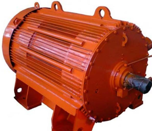
Рисунок 4.12 – Взрывозащищенные АД
