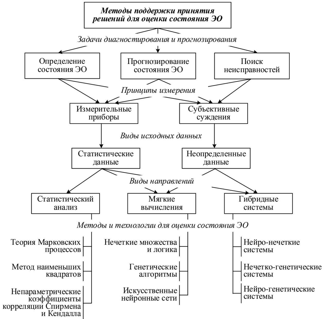
Рисунок 1.10 – Классификация задач, принципов измерения, видов исходных данных, методов поддержки принятия решений для оценки состояния ЭО
