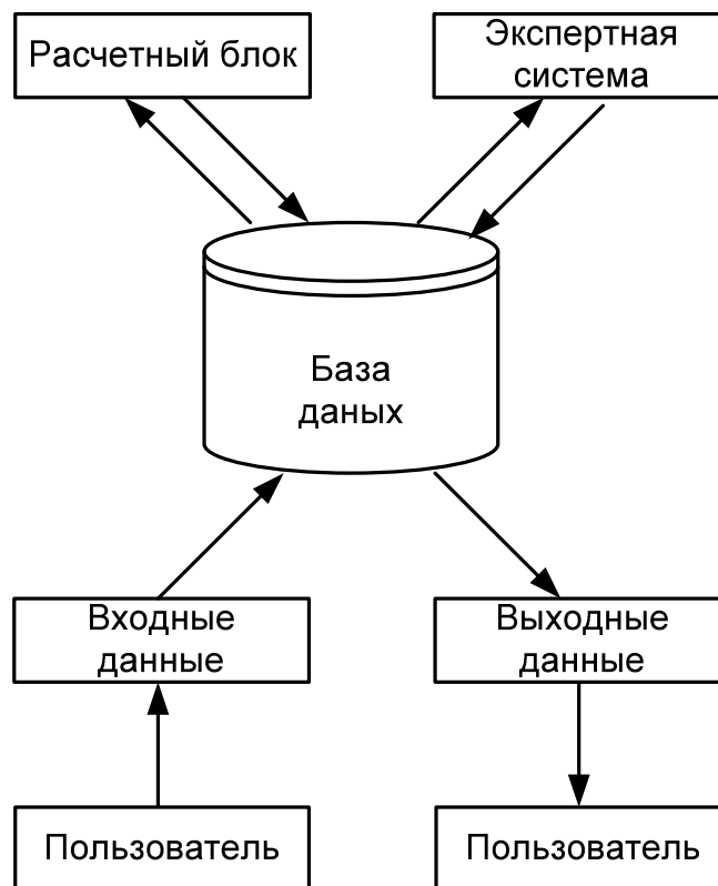
Рисунок 1.6. - Типовая архитектура ИСППР
