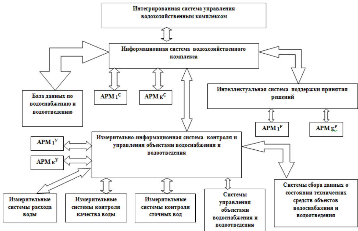
Рисунок 1.2 - Структура интегрированной информационно-управляющей системы водохозяйственного комплекса
