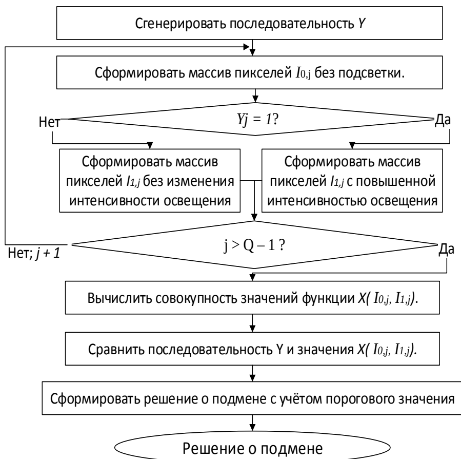
Рисунок 2.18 – Схема, отражающая алгоритм подтверждения подлинности распознаваемого объекта
