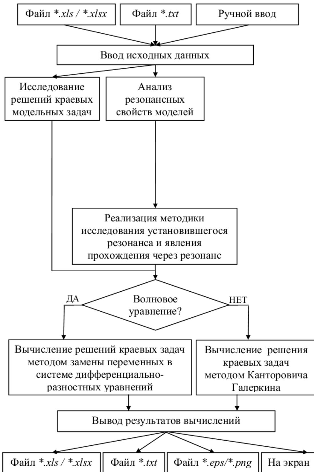
Рис. 5.1. Блок-схема комплекса программ «TB-ANALYSIS»
