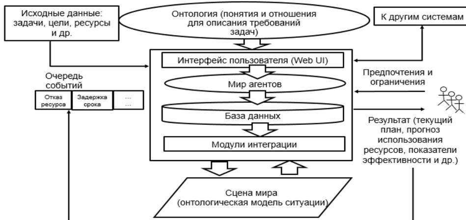
Рисунок 3.1 – Логическая архитектура мультиагентной системы
