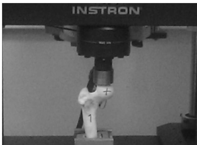
Рис. 2.25. Расположение системы в динамометре INSTRON 5982
