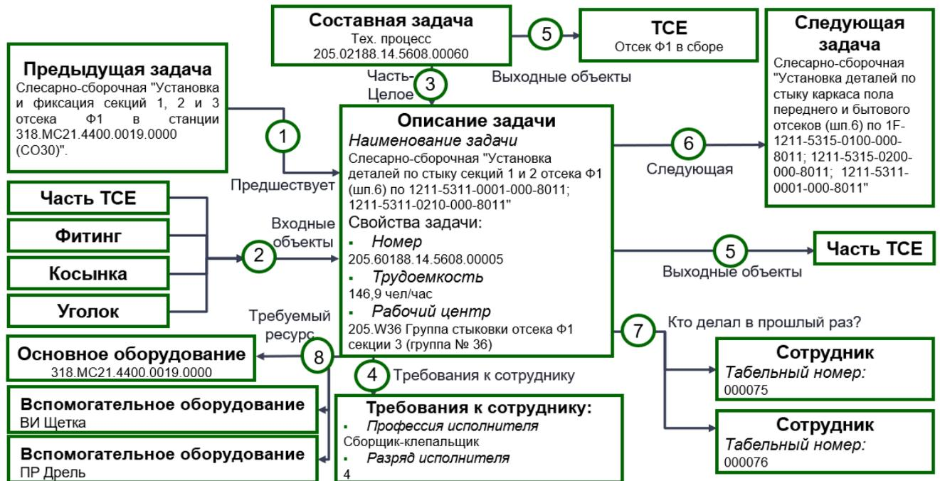
Рисунок 2.6 – Пример спецификации технологической операции сборки самолета МС-21
