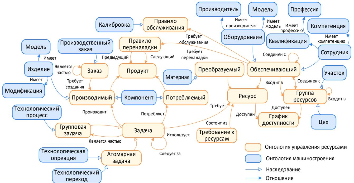
Рисунок 2.4 – Расширение онтологии управления ресурсами на область машиностроения
